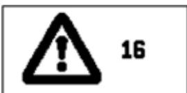
16   | Не срабатывает сенсор задней точки возврата, хотя машина должна находиться в стартовой позиции | <ol style="list-style-type: none"><li>Выключить машину и снова включить после того, как погаснет экран дисплея.</li></ol>                                         |
