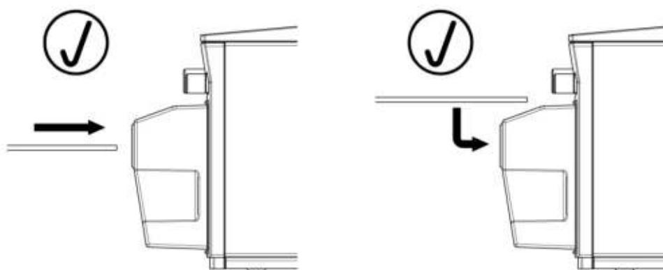
**Наклонно введённый провод может стать причиной неисправности машины!**
