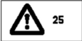
25   | Превышено значение максимального тока электродвигателя                                         | <ol style="list-style-type: none"><li>Проверить настройки на дисплее.</li><li>Выключить машину и снова включить после того, как погаснет экран дисплея.</li></ol> |
